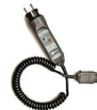
Adaptador WS-03 con botón que inicia la medición (conector UNI-Schuko) (CAT III 300 V)
